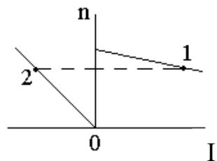
**3. Приведенная скоростная характеристика  $n=f(I_a)$  соответствует двигателю постоянного тока:**
