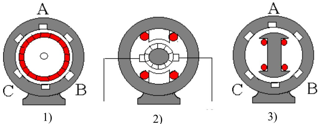
**26. Для создания вращающегося магнитного поля в трёхфазных машинах необходимо:**
