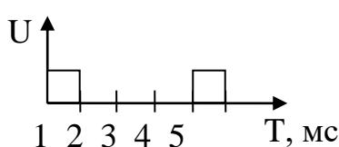
**33. Частота повторения импульсов на входе логического элемента И равна:**
